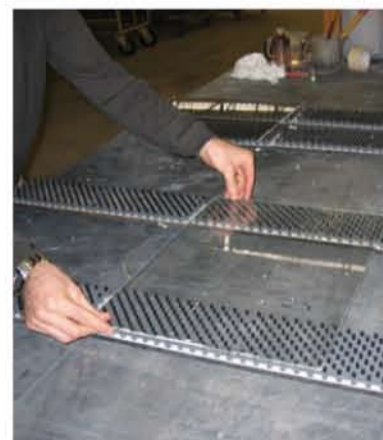
Das Mink Care-System besteht aus unzähligen flexiblen Fasern, die empfindliche Werkstücke zuverlässig tragen.
