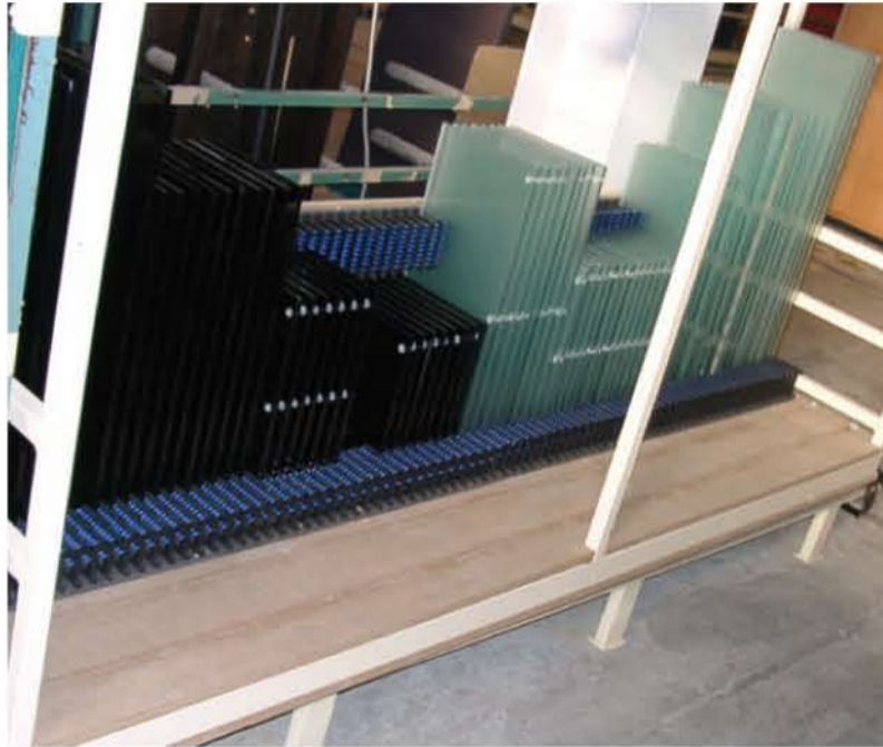
Tausende Fasern schmiegen sich an das Transportgut an, sodass ein Aneinanderreiben einzelner Glasflächen verhindert wird. Bilder: Mink
